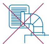
Не присоединяйте дымоотводы от газоиспользующего оборудования к вентиляционным каналам.
