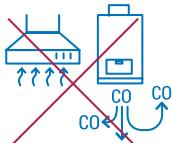
Не включайте вытяжку, когда работают газовый котёл или водонагреватель – угарный газ может попасть в помещение.
